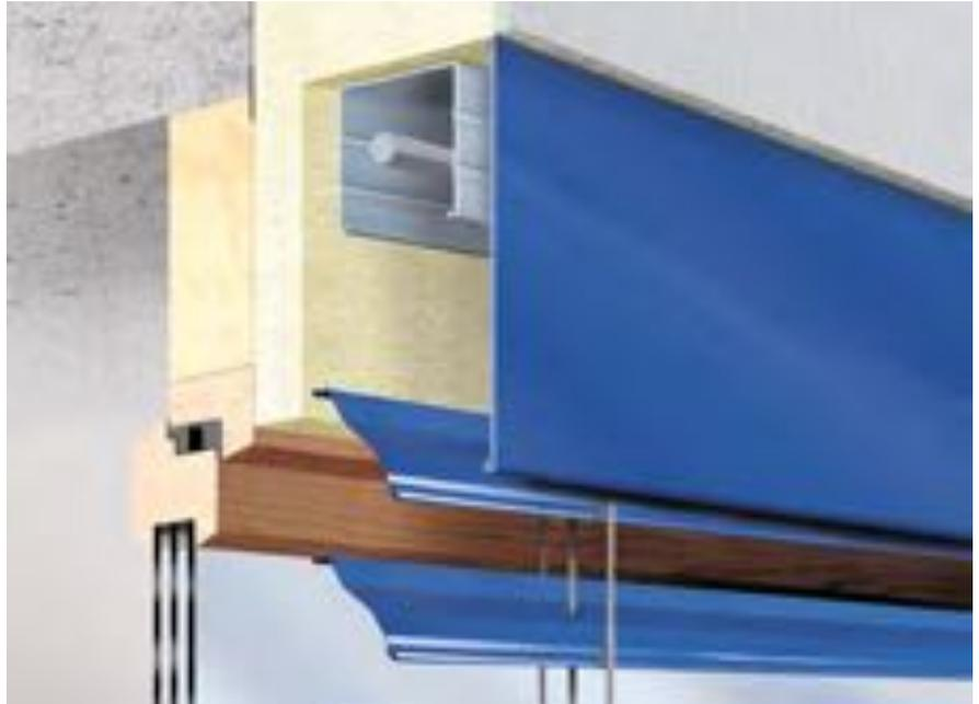
**Eingelassene Führungen Typ L, F und E bei Wärmedämm-Verbundsystemen**
